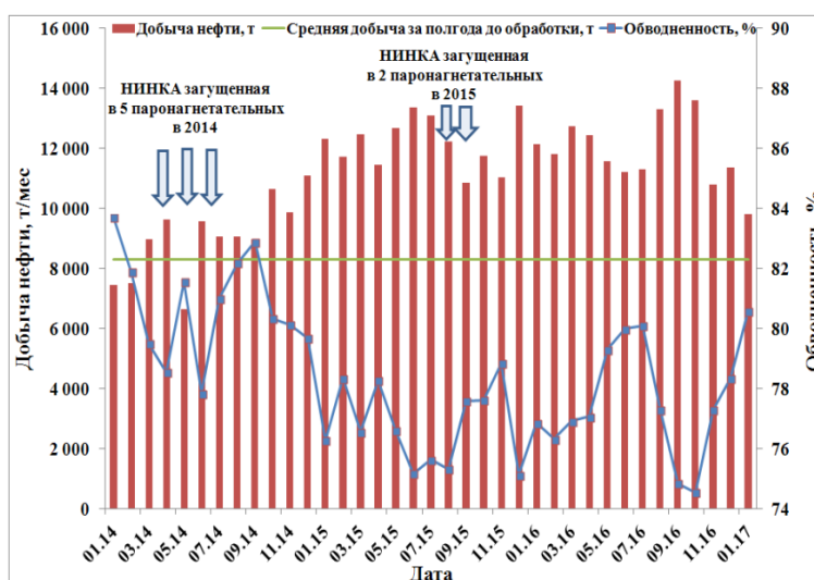
Рисунок 2 – Увеличение дебитов по нефти и снижение обводненности до и после закачки в 2014-2015 гг. композиции НИНКА-3 в паронагнетательные скважины опытного участка пермо-карбоневой залежи Усинского месторождения
