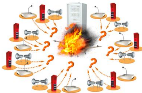
Рисунок 3 – Централизованная система. Выход из строя коммутатора
